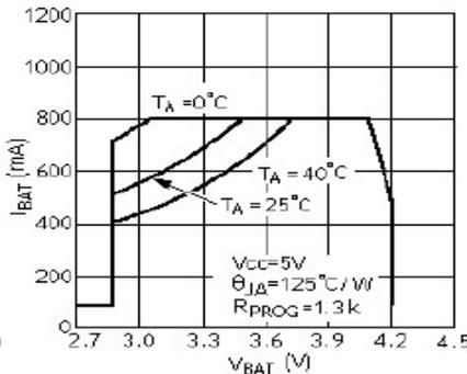
充电电流与电源电压的关系曲线
