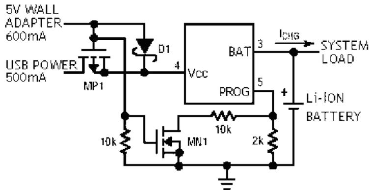
图 6: 交流适配器与USB 电源的组合
