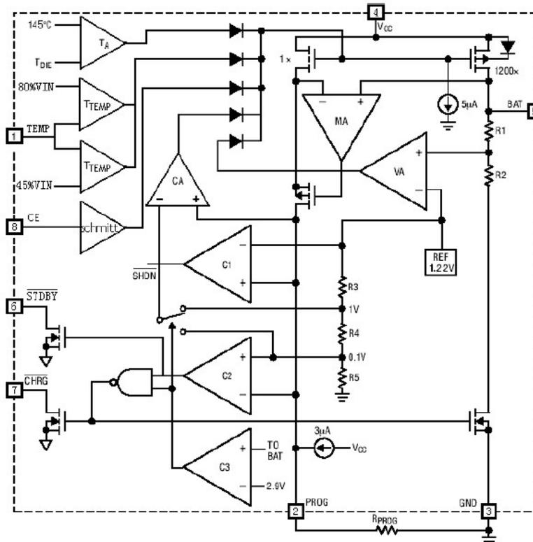
FS4056 是专门为一节锂离子或锂聚合物电池而设计的线性充电器电路，利用芯片内部的功率晶体管对电池进行恒流和恒压充电。充电电流可以用外部电阻编程设定，最大持续充电电流可达 1A，不需要另加阻流二极管和电流检测电阻。FS4056 包含两个漏极开路输出的状态指示输出端，充电状态指示端 CHRG 和电池故障状态指示输出
